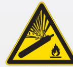
Pericolo bombola pressurizzata W029
