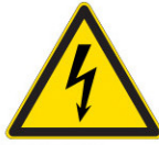
Pericolo elettricità W012
