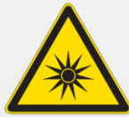
Pericolo radioazioni ottiche W027
