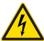
Pericolo elettricità W012
